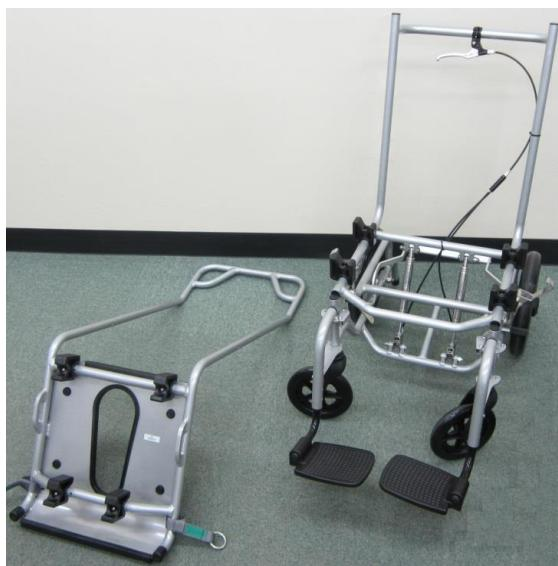
台車からチェアを分離し、床に左の写真のように裏面が見えるように置きます。
