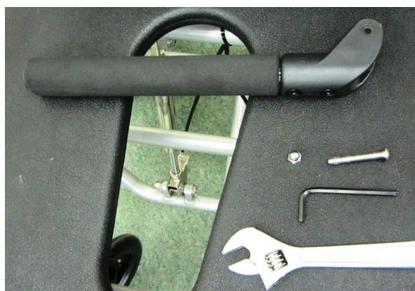
ボルトを緩め続けると、フレームから取り外す事ができます。このとき、内側のナットも同時に外れますので、無くさないように注意して下さい。
