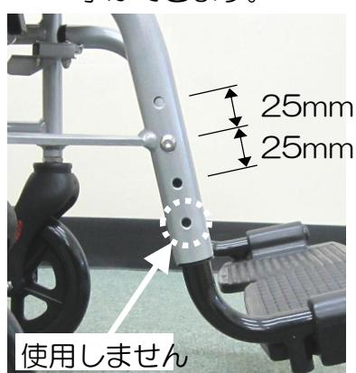
工場出荷時、フットプレートの位置は、上から2段目に設定されています。搭乗者の身体状況に合わせ、適切な位置に調整をする事ができます。
